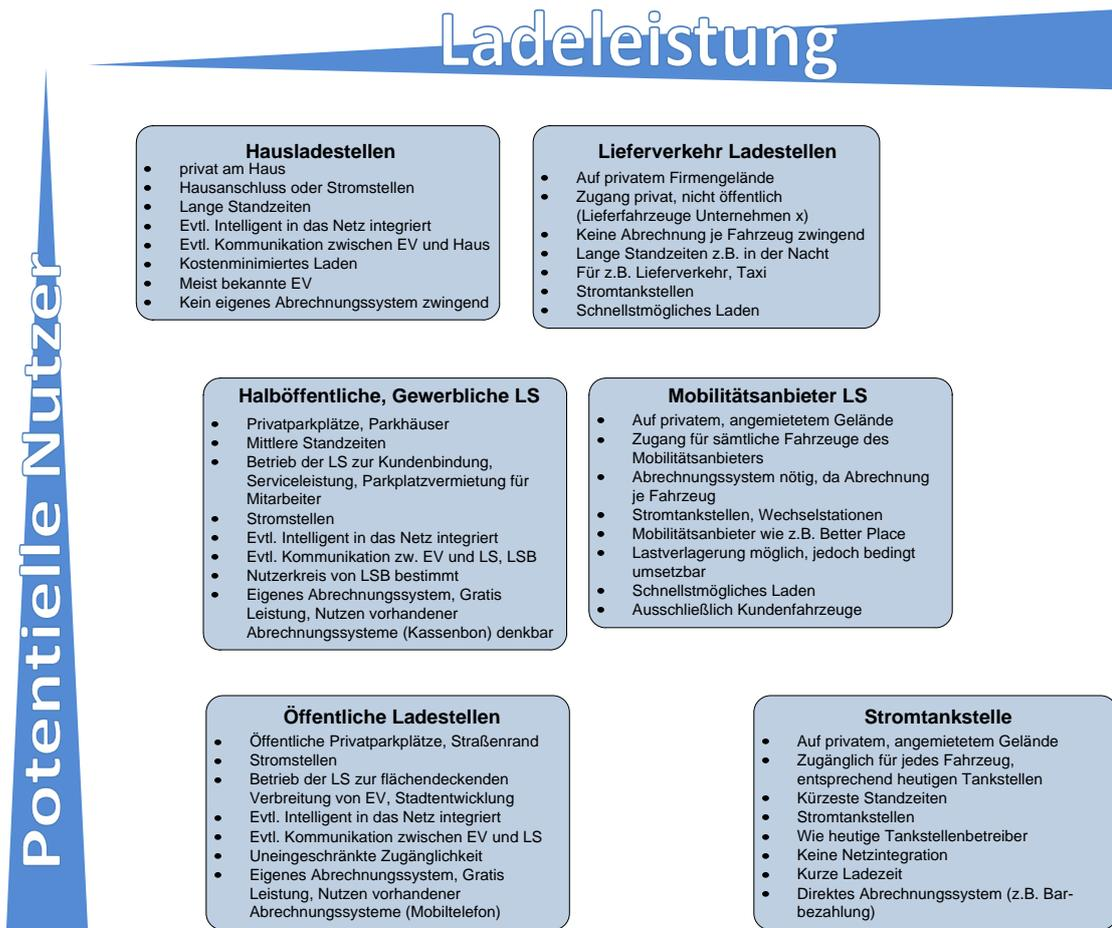
Abbildung 2.9: Einordnung potentieller Ladestationskonzepte an verschiedenen Ladeorten anhand der Ladeleistung und Nutzeranzahl.
